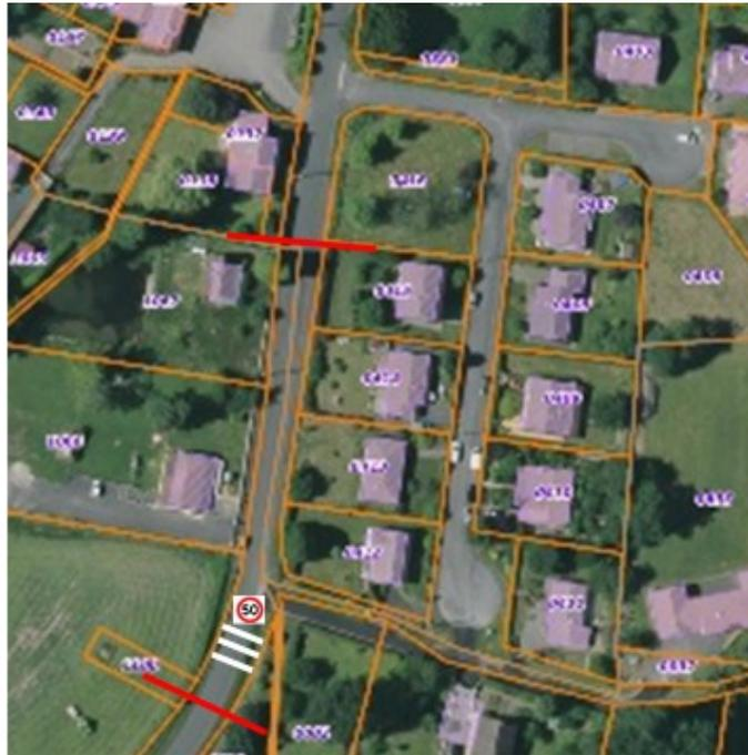
La séquence débute au panneau Blond. Il a été proposé de **marquer les 4 entrées de Blond** par des bandes au sol en résine de plus en plus rapprochées et d'ajouter à la peinture au sol le marquage 50 km/h. Un radar pédagogique va être installé au milieu de la séquence.
