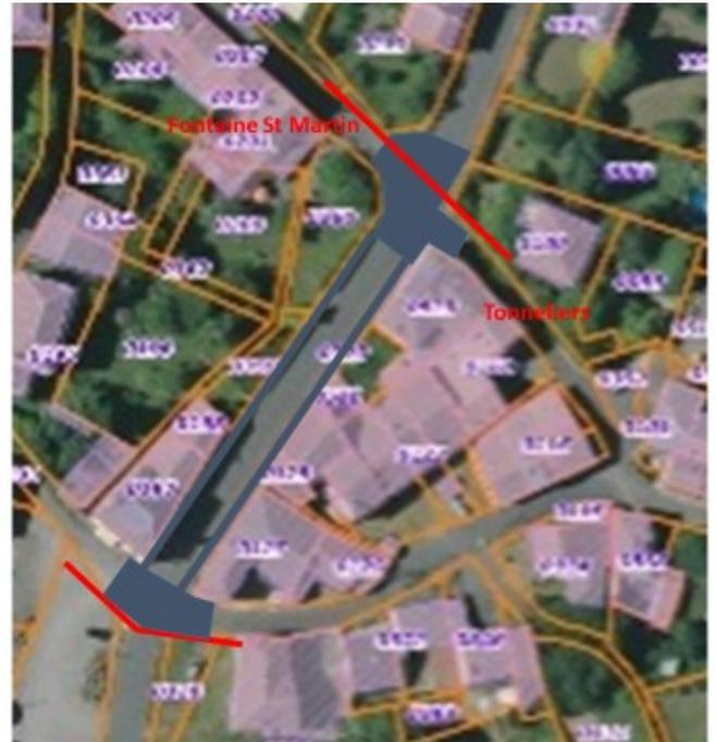
Cette séquence est toujours à 30 km/h. Elle est marquée avec des seuils et des caniveaux en pavés à ses 2 extrémités (rues des Rochers/Luppé et rues de la Fontaine St Martin/Tonneliers). Les trottoirs sont trop étroits à certains endroits. Pour la mise aux normes, il est proposé de les remplacer par des larges caniveaux en pavés. Les stops sont conservés. TV a proposé la végétalisation des façades.
