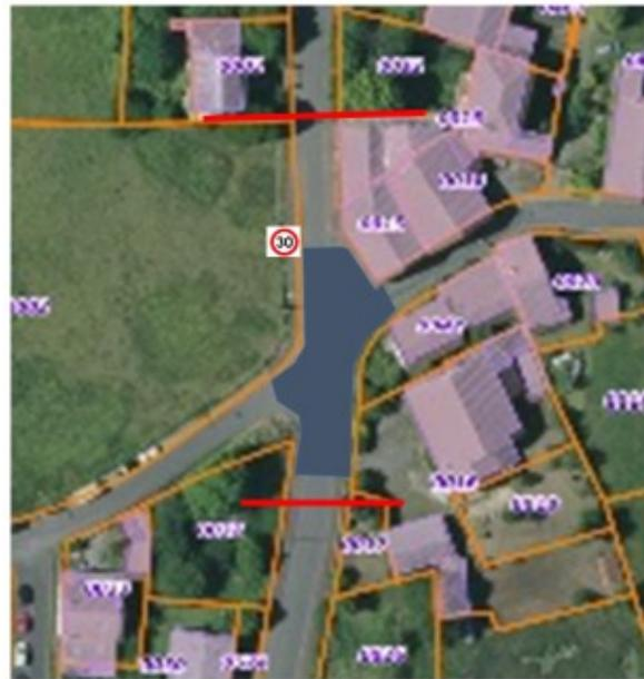
Cette séquence est limitée à 30 km/h. Il est prévu un large seuil en pavés à l'intersection. Les stops sont conservés.
