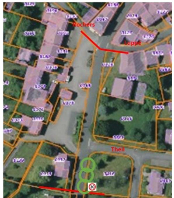
La séquence débute par un panneau 30 avant un rétrécissement de la chaussée en une voie au niveau de l'espace vert public. Ce rétrécissement sera planté d'arbres de haut jet en alignement en relation avec les plantations de la place. L'aménagement de la place et de ses abords fera l'objet d'un prochain atelier.
