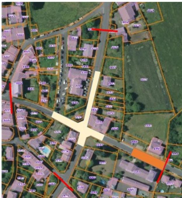
Cette séquence reste à 30 km/h. Il est prévu un grand plateau surélevé devant les écoles. L'approche de l'intersection D3/D5 sera marquée par une résine de couleur. Pour sécuriser le carrefour, il faudrait rétrécir la chaussée de la D3 sur quelques mètres au niveau du carrefour pour assurer une meilleure visibilité au niveau des stops sur la D5 qui pourrait être avancés. Pour éviter le stationnement sur ces trottoirs élargis, des bornes pourraient être installées.
